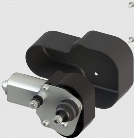
Self-Oscillating Windscreen Wiper Motor İçten Mekanizmalı Silecek Motoru
